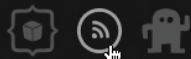
FIG 3.19 : Présentation de l'état : hover des icônes dans le pied de page obtenu en ajustant la propriété opacity
